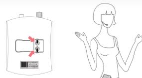
ベルトクリップを本体の背面に付属ビスで固定すると、本体を腰に掛けて使用できます。
